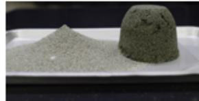
実験①乾燥した砂と湿った砂をひっくり返して、土砂の安定にはある程度の水分が必要なことを理解する実験。
