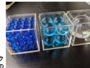
実験③10cmのアクリル水槽の中に様々な直径の球体を詰め、粒子の大きさの違いと、粒子の間隙率の大きさを測定する実験。
